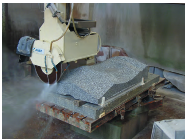
FIGURA 39. Execució d'un element de pedra amb un disc seguint un procés complet de mecanitzat.
